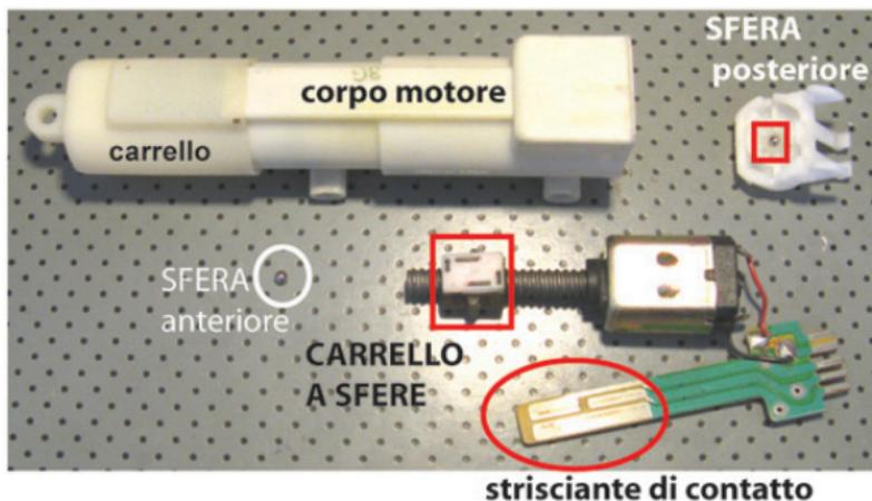
Per fargli manutenzione bisogna aprire con un cacciavite piatto sottile il tappo posteriore, poi con delle pinze estrarre insieme la basetta dello strisciante e il corpo motore, ci sarà una resistenza dovuta dai ganci del carrello che devono sganciarsi. Estratto tutto cercare la sfera anteriore che in fase di montaggio sarà da mettere sulla punta della vite senza fine dove scorre il carrello a sfere.
