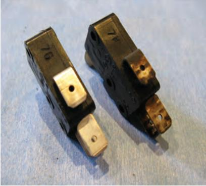
Ecco qui a lato uno switch del riscaldamento a led dopo e prima della cura.
